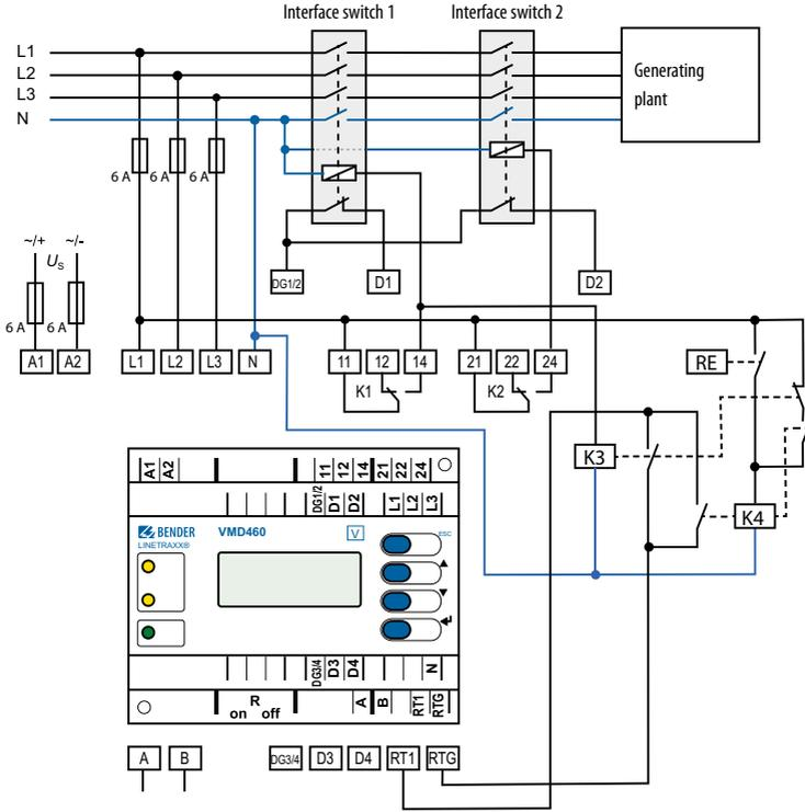
**Wiring diagram EREC G99, G98, C10/11, DIN V VDE V 0126-1-1
