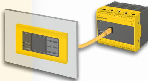
Die Displayeinheit FP200 wird über Halteklammern in der Front montiert und über ein mitgeliefertes RJ45-Verbindungskabel mit dem displaylosen Grundgerät verbunden. Diese Einbauvariante ermöglicht die Anzeige des Gerätes in der Schaltschrankfront, ohne dass die Netzankopplung mit bis zu 1.000 V mitverlegt werden muss.
